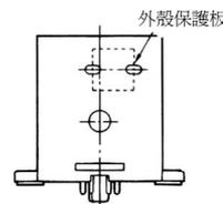
MM2XP(N,-D) 型如圖, 3-φ 10 孔位在外殼的側面
