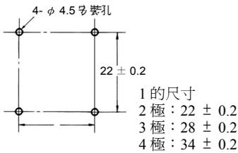
安裝金具 (S 金具) 露出型的安裝金具, S 金具也可使用 R99-03MM □ 型
