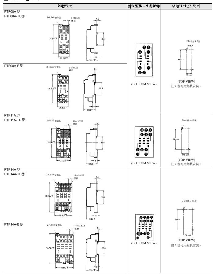
註:PTF08A, PTF08A-E, PT08 和 LY1 之繼電組合時端子 NO.  $\bigcirc$ -  $\bigcirc$   $\bigcirc$   $\bigcirc$   $\bigcirc$   $\bigcirc$  前各別短路(10A 以上使用)。
