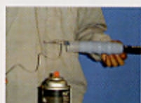
4. 反時針方向拉掉 內支撐塑膠帶
